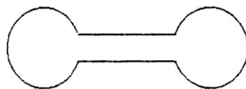
Горизонтальный знак в виде гантели белого цвета, выкладываемый на сигнальной площадке, означает, что воздушным судам следует производить посадку, взлет и руление только на ВПП и РД.
