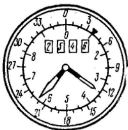
Рис. 18.1. Прямопоказывающий прибор дальности и азимута штурмана (ППДА-Ш)
